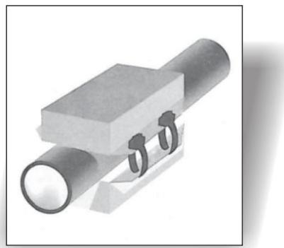
As Células de Potência ENEFLOW 1000 são projetadas para serem usadas em todos os tipos de tubos (cobre, latão, galvanizado, PVC, etc.) até 1,75 polegadas de diâmetro externo.
