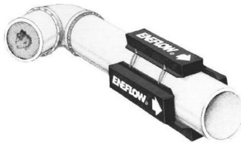
*As células de potência devem ser fixadas firmemente ao redor do tubo usando as tiras plásticas autotratantes fornecidas. As células de potência devem ser orientadas com a direção do fluxo de fluido conforme as setas nas unidades.*
